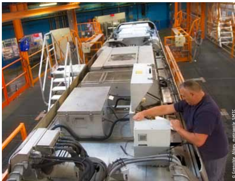
Un technicien pose des capteurs mobiles sur le toit du tramway de la ligne A.
