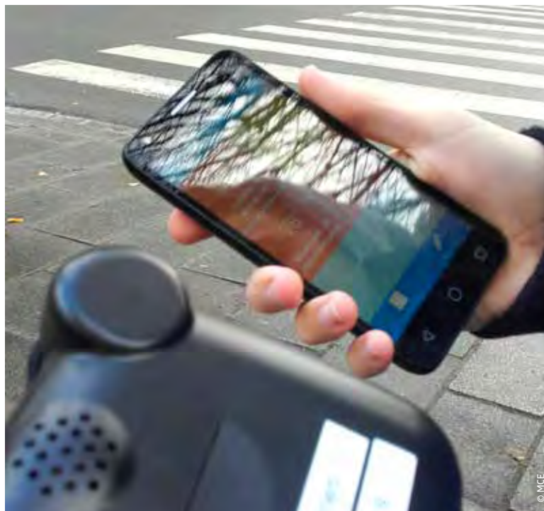
Les capteurs utilisés mesurent un seul paramètre : les particules fines (PM2,5).
