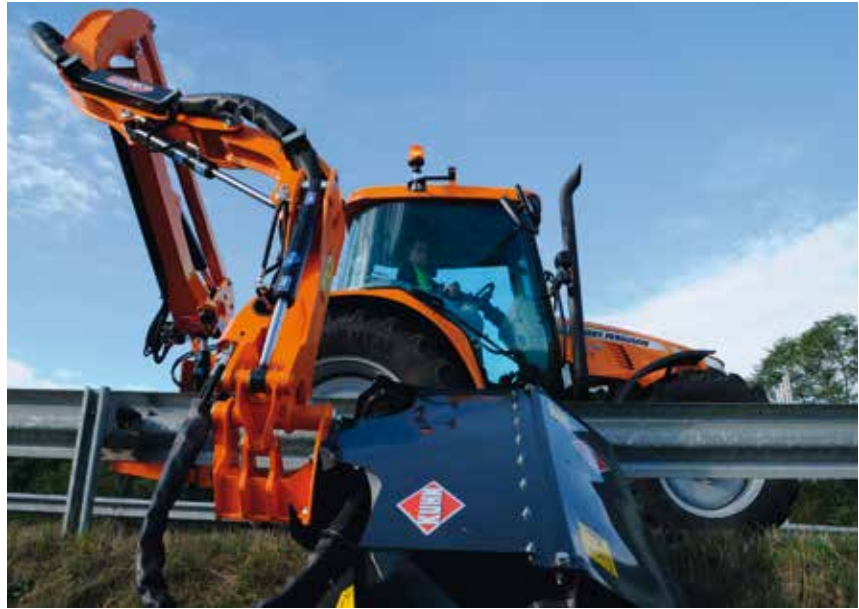
La machine PRO-LONGER présente deux modèles à bras télescopique : une version de 6,10 m de portée horizontale et une version 7,40 m, avec une cinématique parallélogramme via un dispositif électronique.
