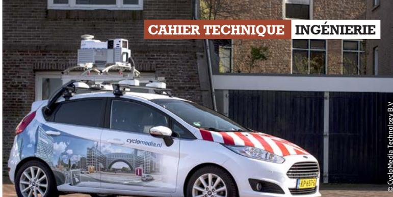
Véhicule équipé pour l'acquisition de vues immersives 360 degrés, avec précision de 5 à 10 cm.
